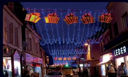
LES CIELS DE RUE SE RACCORDENT LATÉRALEMENT. CHAQUE CIEL DE RUE DOIT ÊTRE SOUTENU PAR UN CÂBLE TOUTS LES 10M MINIMUM.
